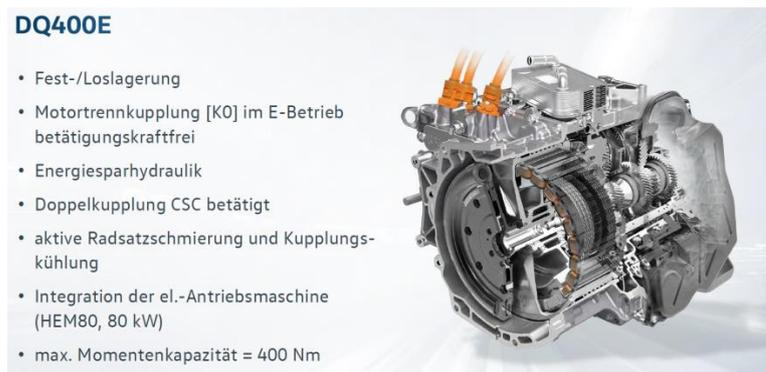
Figura 24: Exemplo de Transmissão "Híbrida" do VW DQ400E
