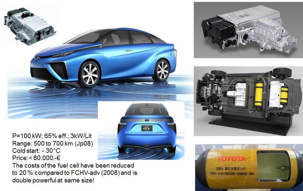
Figura 14: Veículo Toyota "MIRAI" (= Futuro) e componentes FC
